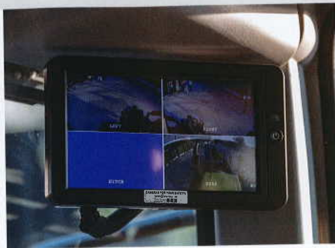
■ NÄYTTÄVIÄ NÄYTTÖJÄ. Uusi ohjausjärjestelmä mahdollistaa koneen ominaisuuksien laajan muokkaamisen, erilaiset profiilit ja kattavat ohje- ja tukitoiminnot. Lisävarusteinen kamerajärjestelmä näkee tarkasti koneen katveisiin.
