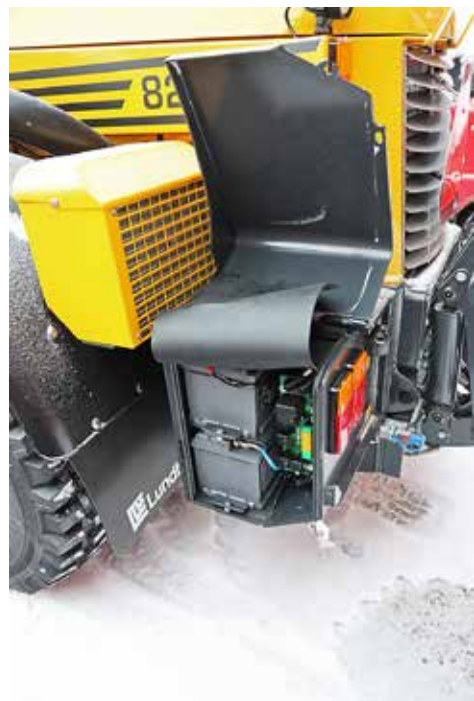
↑ Akut on sijoitettu vasempaa takakulmaan. AdBlue-säiliö on puolestaan vastakkaisella puolella.
