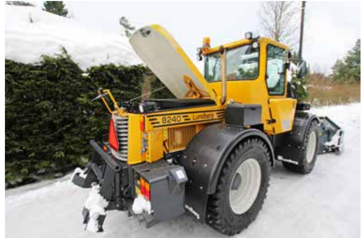
↑ Avautuvasta konepeitosta huolimatta moottoritila on umpinainen ja remonttien tekoa varten peltejä joutuu purkamaan irti.
