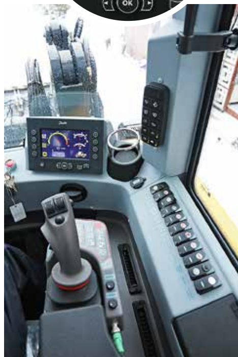
↑ Puomiston liikenopeuksia voi säätää liikekohtaisesti. Katkaisimien toimintoja on selkeytetty opastarroilla.
