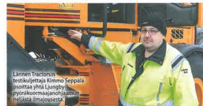
Lännen Tractorsin testikuljettaja Kimmo Seppälä osoittaa yhtä Ljungby-pyöräkuormaajajohtamoon neljästä ilmajousta.
