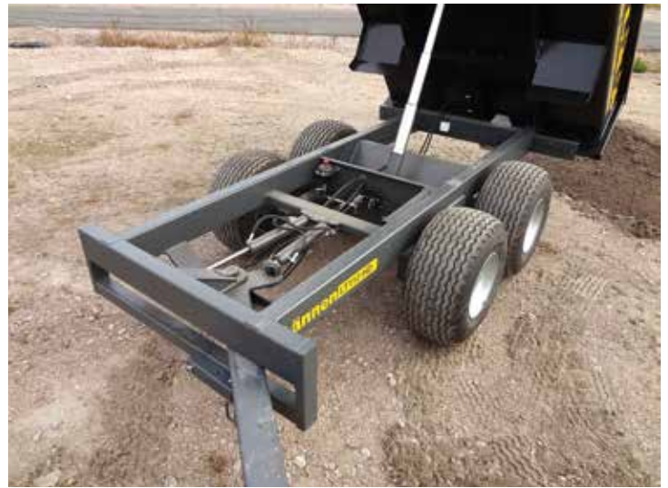
↑ Aisan kääntöä varten vaunun runkoon on sijoitettu kaksi hydraulisyliinteriä.
