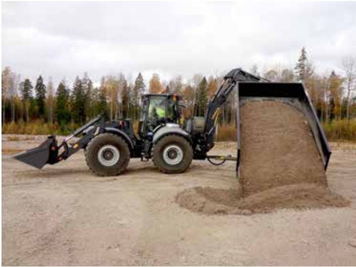
↑ Kääntyväisäinen LT110-perävaunu on mahdollista kipata 90 asteen kulmassa koneen ajolinjan sivulle.
