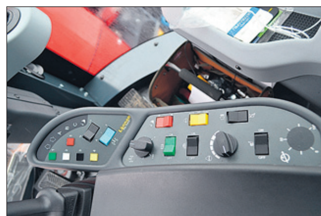
Lännen 8600K ohjaamo on tilava, hiljainen ja sieltä on hyvä näkyvyys ympäristöön. Työtä helpottaa uusi kyynärnojaan sijoitettu ohjainpaneeli, johon on ergonomisesti sijoitettu koneen tärkeimpien toimintojen hallintaan tarvittavat kytkimet.
