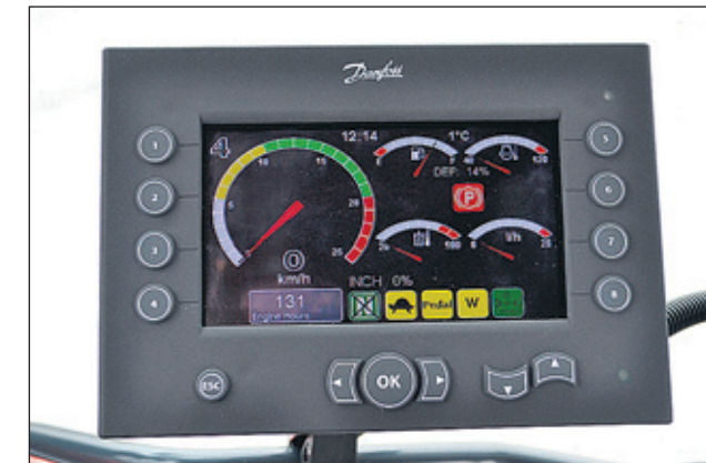
Näytöltä voi seurata kaikkia koneen tapahtumia, niin polttoaineen kulutusta kuin huoltoväliäkin.
